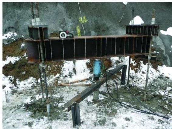
鉛直載荷試験
