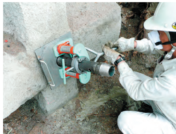
簡易な油圧引抜治具(重量=11kg)
