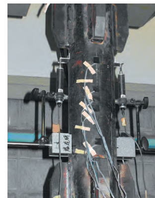
鋼管ジョイントの試験状況
