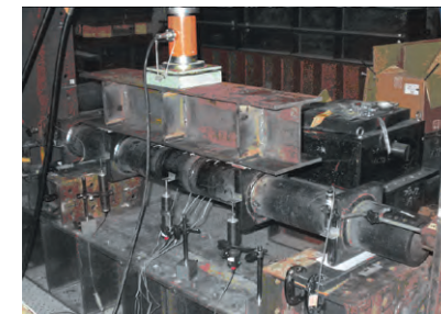
鋼管ジョイントの試験状況
