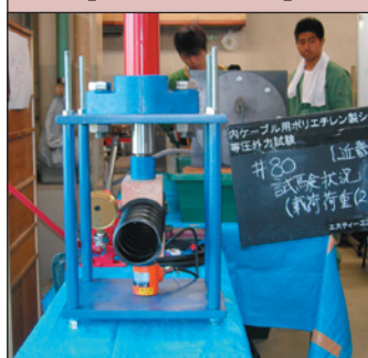
等圧外力抵抗性試験 【JSCE-E705-2010】
