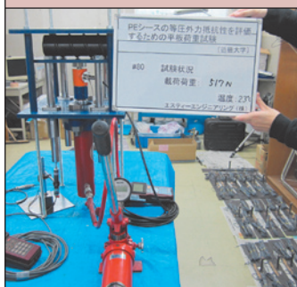
平板荷重試験(23℃) 【等圧外力抵抗性の評価】
