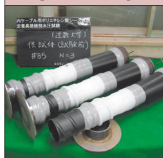
定着部接続部漏れ試験 【JSCE-E707-2010】
