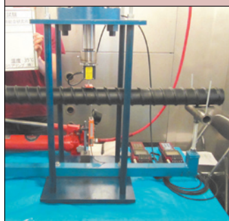
曲げ特性試験(35℃) 【支持間隔の評価】
